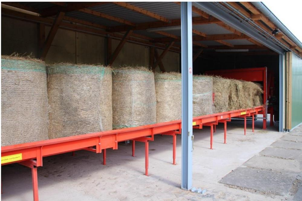
Abbildung 36: Förderband und Ballenauflöser im Heizwerk Malchin. Die Länge des Förderbandes bestimmt die Brennstoffbevorratung (Schröder et al. 2017).
