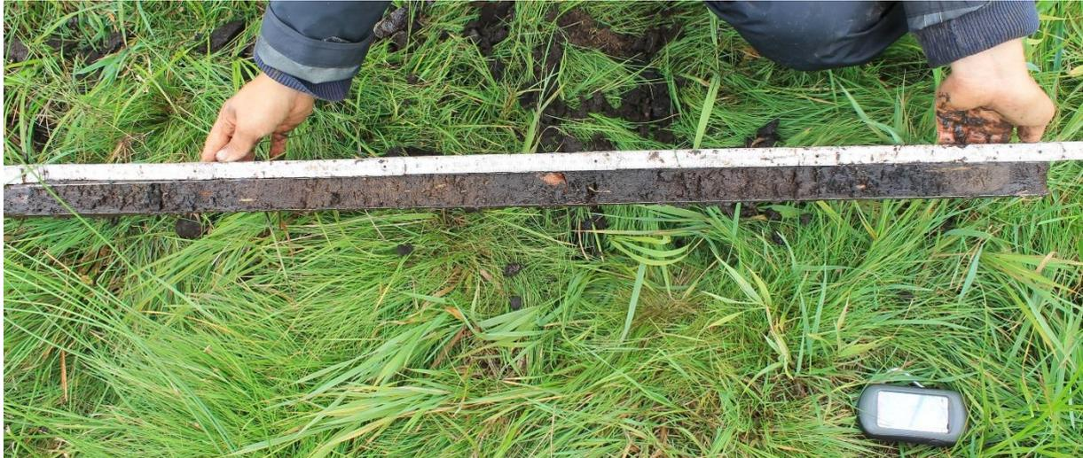
Abbildung 16: Beispiel eines Bohrkerns, Dokumentation der Torfmächtigkeit, Lage, Torfart, Zersetzungsgrad. Foto: F. Reichelt
