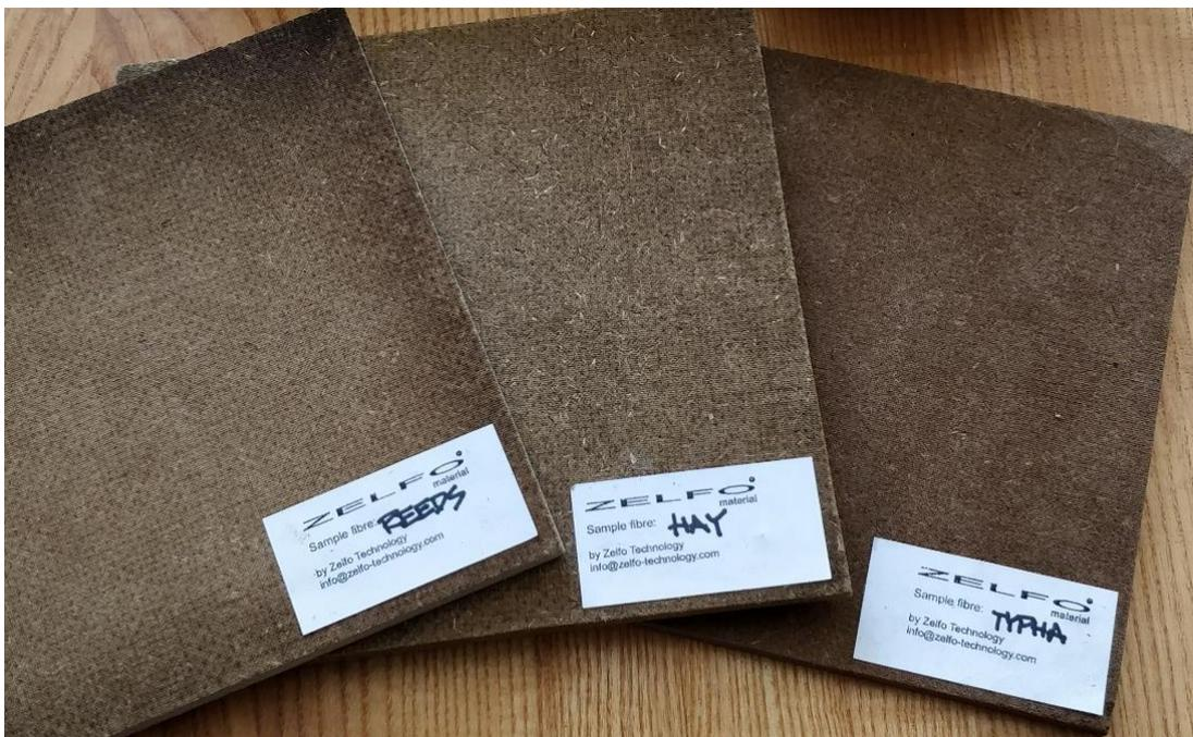
Abbildung 40: Platten, z.B. als bau- und Möbelwerkstoff, aus 100% Heu aus der Hammeniederung (Mitte), 100% Rohrkolben (rechts), 100% Schilf (links). Gepresst ohne Bindemittel von ZELFO Technology. Foto: S. Abel
